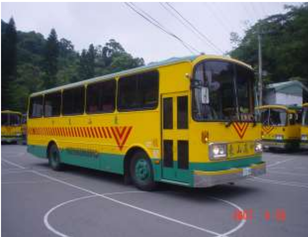
校車顏色及標誌標準圖（前、右側） 車門旁應標示牌照號碼及乘客人數
